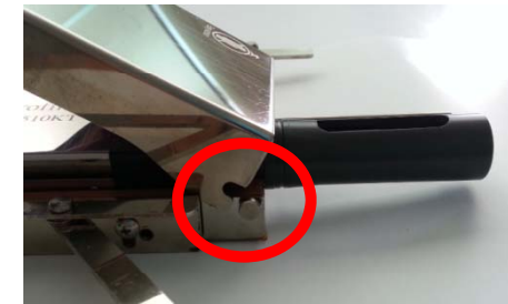
③ 상단 부 내열케이스를 하단부 케이스 센서 방향의 고리 부분에 장착합니다.
