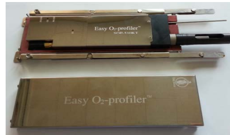
② 하단부 내열케이스에 SOP-501/510KT 본체를 장착합니다.
